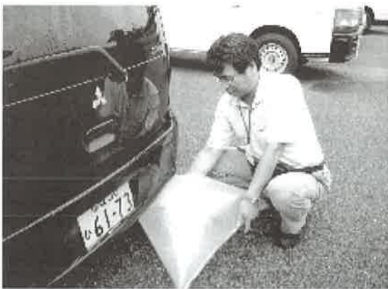
大気汚染調査、ガス検知管を利用して自動車の排気ガスを計測
