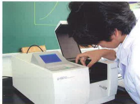
分光光度計で、吸収スペクトルを計測
