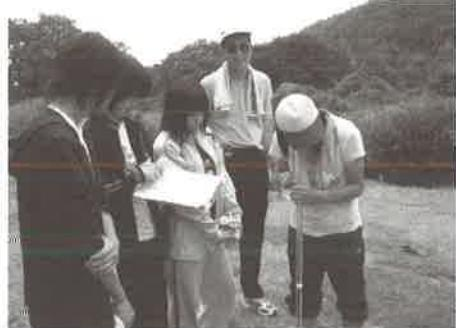
図1. 河川の透視度の計測
